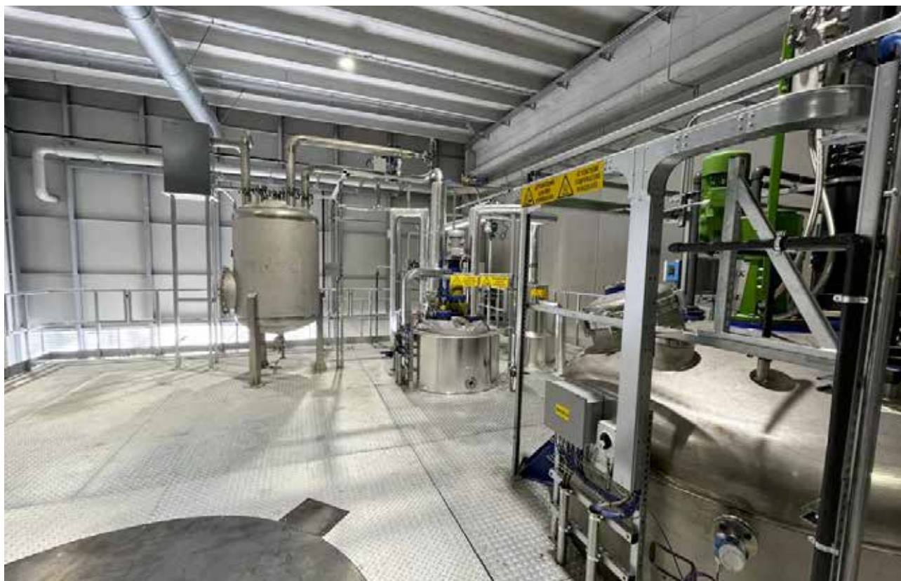
Nella foto una parte dell'impianto sperimentale di inertizzazione dell'amianto della friulana costruzioni
